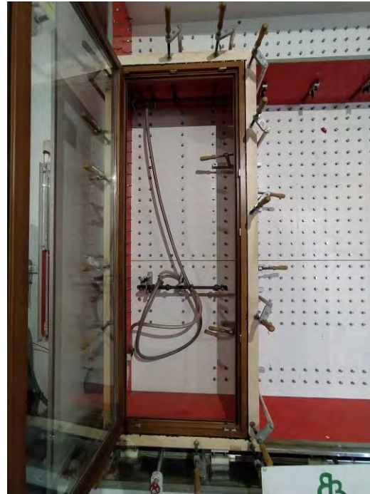
Montaje de la probeta
