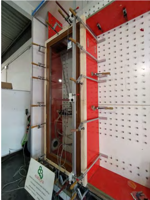
Ensayo de resistencia al viento y comprobación de funcionamiento.
